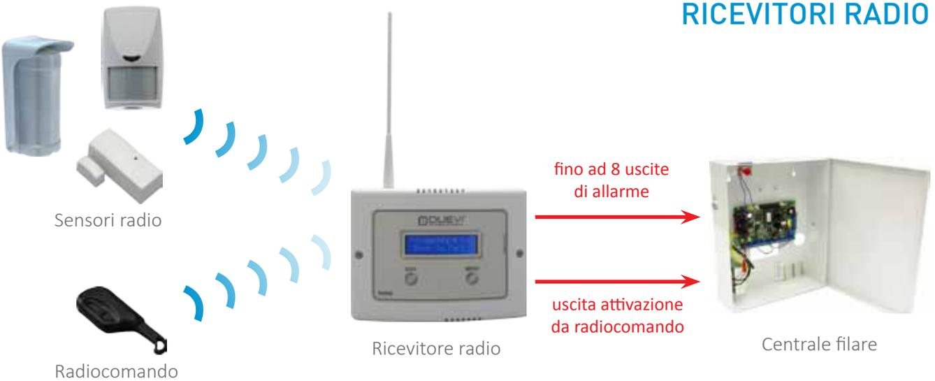
I ricevitori radio con uscita relè rappresentano un valido supporto quando vi è l'esigenza di aggiungere sensori radio oppure radiocomandi Duevi ad una generica centrale di allarme filare.
